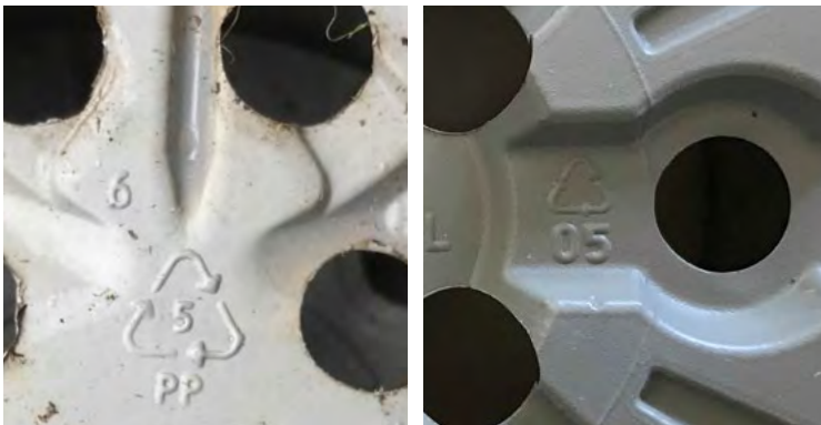
Die meisten Töpfe bestehen aus Polypropylen (PP), was man am Recyclingcode auf dem Topfboden erkennt. Fast alle Trays sind aus Polystyrol (PS).
